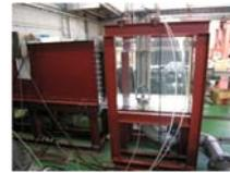
水槽と測定装置、150mm径配管、200mm円盤
