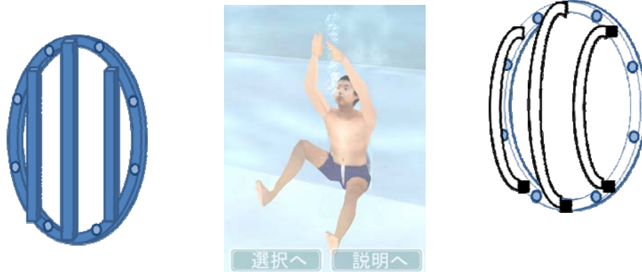
(a) 平面的な金具と吸い付かれた模式図 (CIPEC の HP より引用) (b) 大きく閉塞される事のない吸い込み防止金具
